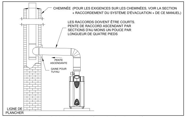
Figure B-1 Installation type d'évacuation dans l'atmosphère
