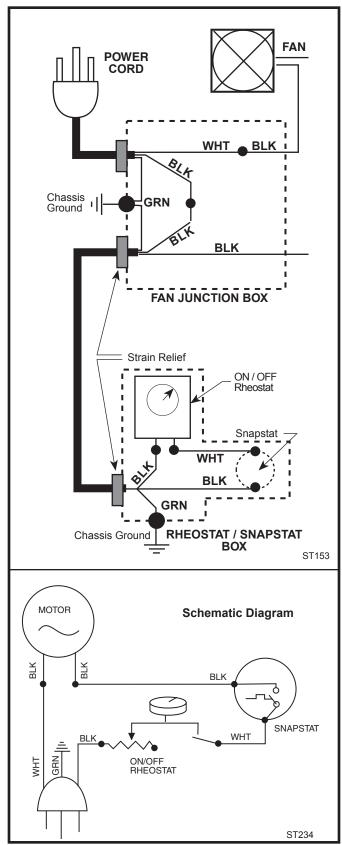
Fig. 81 Stardance fan circuit.
