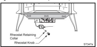
Fig. 17 Attach the fan rheostat.
