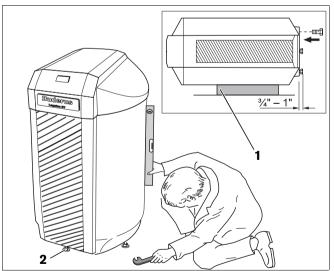
Fig. 5 Leveling the DHW tank vertically
