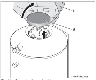
Fig. 12 Removing the casing lid *Item 1:* Casing lid
