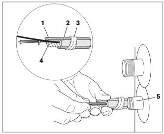
Fig. 8 Installing the DHW temperature sensor
