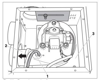
Fig. 52 Removing venting fan
