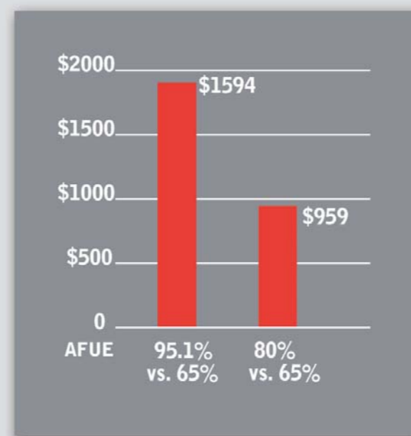
3-Year Heating Savings 95.1% and 80% AFUE unit vs. 65% AFUE units
